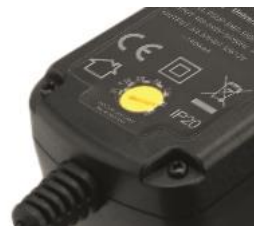
Poză 3 – Selector tensiune
